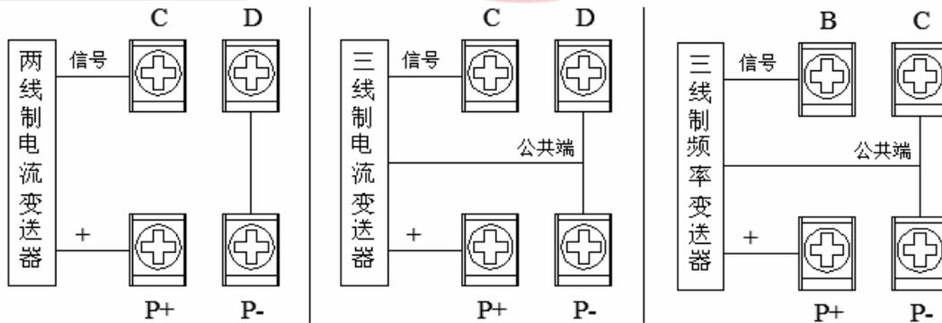
变送器接线方式 (仪表馈电)
