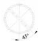
6.1.2.2 测量气体时取向上倾斜 45° 安装。
